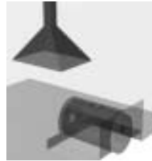
〈그림 30〉 보조후드의 3차원 형상 18m/s로 흡인하는 속도 조건을 주었다.
