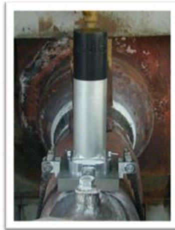
그림 13. 장비 부착 (Chain system 적용 모습)
